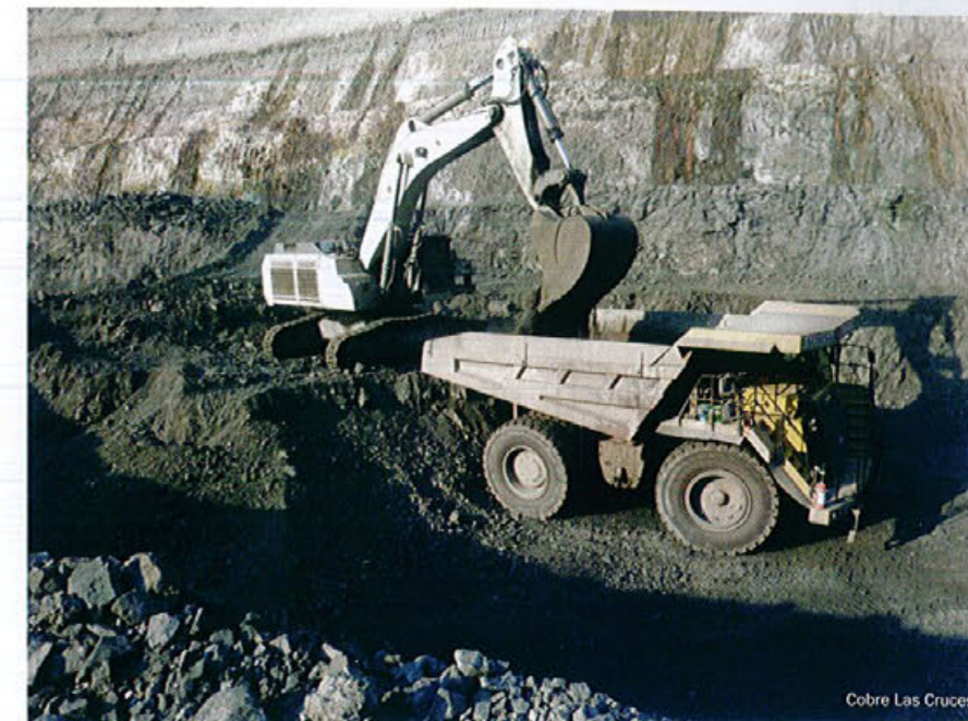
Figura 3. Retroexcavadora LB 9100 de 7 m 3 cargando mineral en el fondo de corta sobre un volquete CAT 777.
