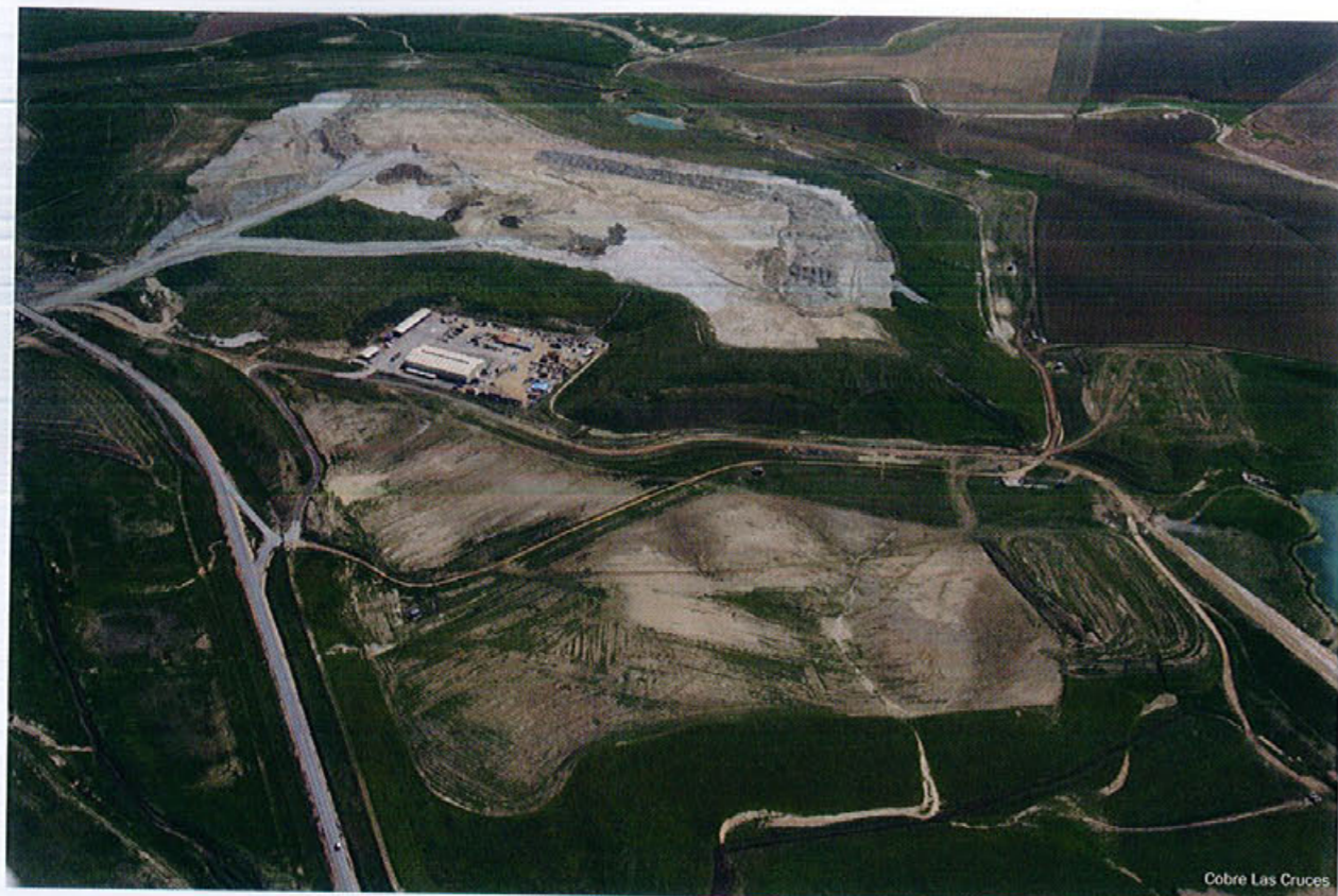
Figura 4. Panorámica de la escombrera oeste de margas. Se observa en segundo plano la fase 1 de vertido (junto a las instalaciones del almacén general) con el perímetro cubierto con tierra vegetal. En primer plano, la superficie de la fase 2 preparada para el inicio del vertido, tras la retirada y acopio de la tierra vegetal.
