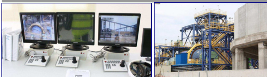
Sobre estas líneas imágenes del panel de control y del molino de bolas dentro de la zona de planta.
